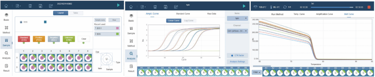
Diversified Progem Settings 각 well 별로 분석에 필요한 Layout을 설정 가능 Run-Amplification Curve 실시간 증폭량을 그래프로 확인 Run-Melting Curve Melting 온도를 실시간으로 확인
